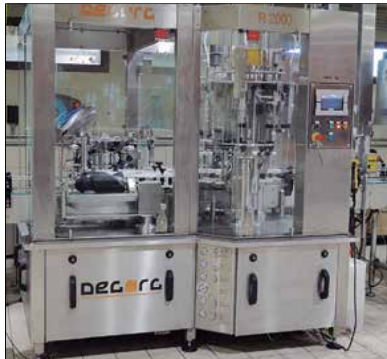
Imatge de la màquina de desgorjar i licors Degorg. ✳ INTECPRO & SOLUTIONS
