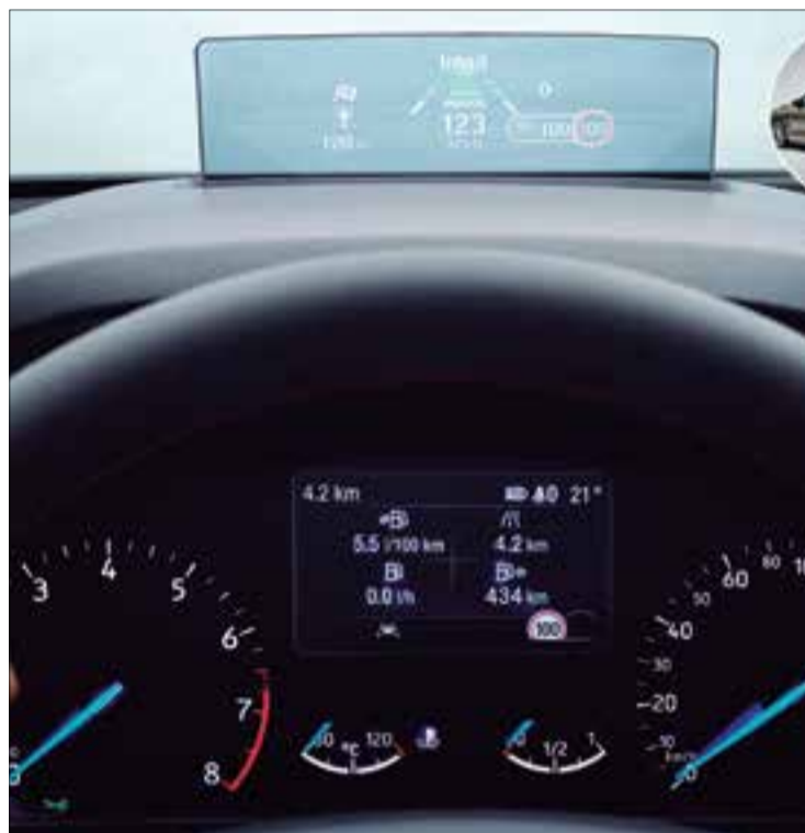
Assistent de conducció head-up display del nou Ford Focus. * FORD
