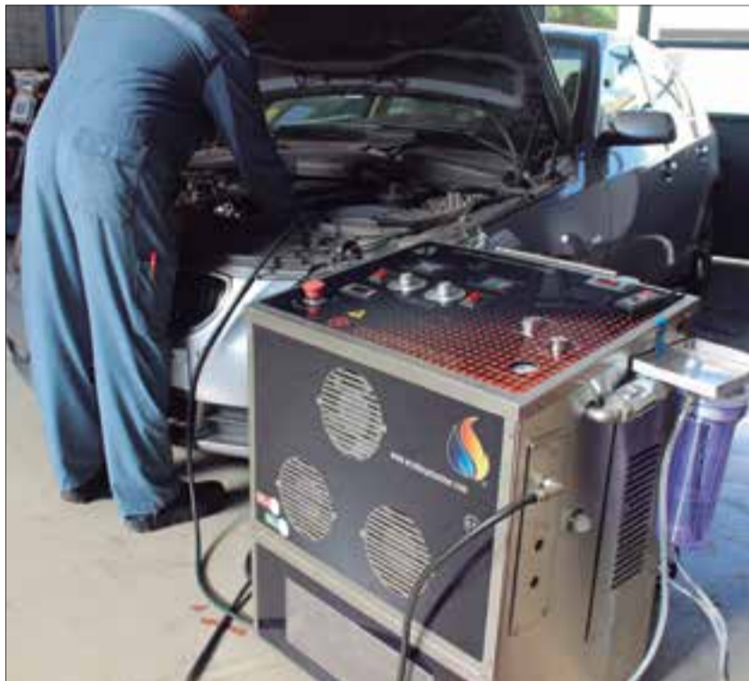
Un operari, descarbonitzant els circuits d'un vehicle. * LA FURA
